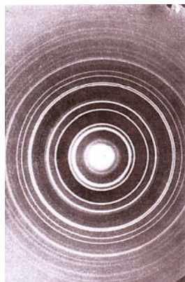
περίθλαση ηλεκτρονίων 50 keV από κράμα Cu_3Au
