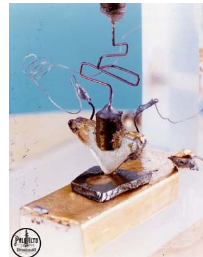
τρανζίστορ σημειακής επαφής Γερμανίου, Bell Labs
