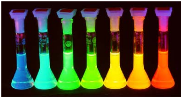
Σχήμα 8.10. Φθορισμός απο φυαλίδια με κβαντικές τελείες CdSe, τα οποία έχουν εκτεθεί σε υπεριώδης ακτινοβολία (πηγή: D. Talapin, University of Hamburg ).
